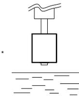
Contacto CERRADO cuando el flotador esta sumergido en el liquido.
