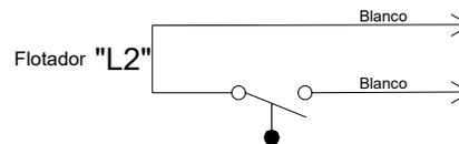
Contacto ABIERTO cuando el flotador esta por encima del nivel del liquido.
