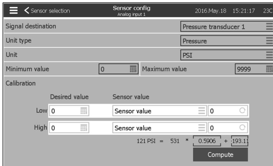
除线路电压和电流传感器外，其他传感器都可通过相同的方式校准。信号终点、单位类型、单位、最小值和最大值等变量均已在工厂中设置好，但可现场校准。
