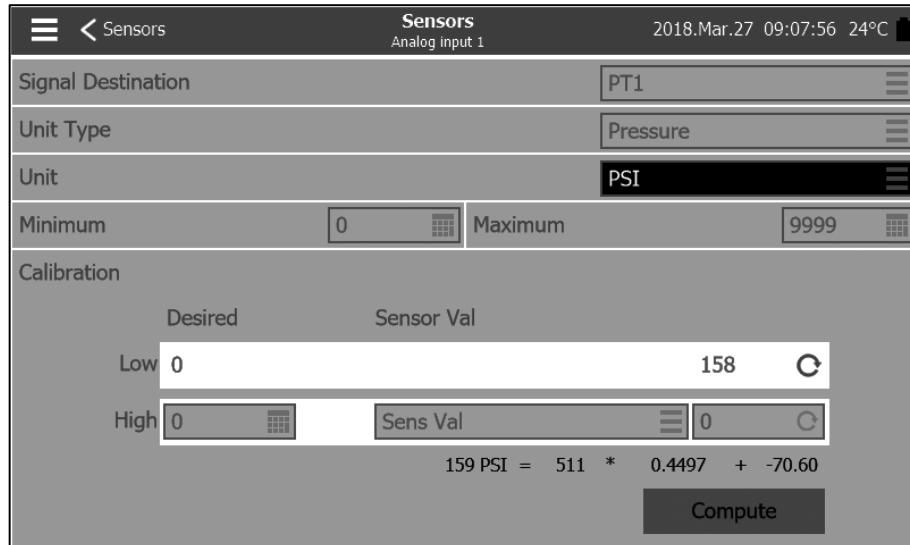
对于压力传感器PT1，首次上电时自动获取低点（零点）。它可以通过按蓝色圆形箭头重新获得。需要输入高点才能校准传感器。
