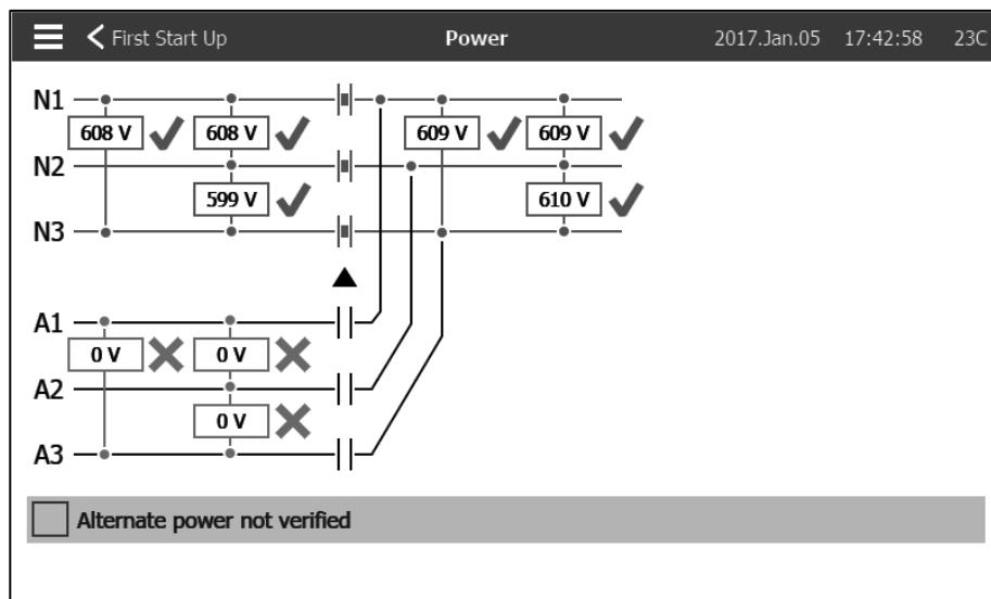
验证 N1-N2、N2-N3 和 N1-N3（标称）显示的常规电源与消防泵控制器的铭牌信息是否一致。消防泵控制器将自动验证常规电压与标称电压是否一致。如果全部正常，会显示绿色勾号。
