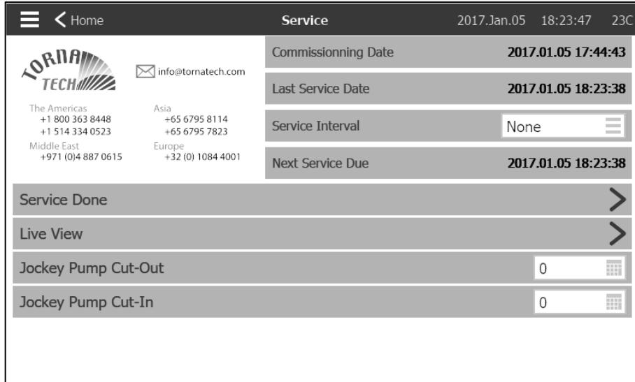
此页面显示如何获取技术支持，包括试运行日期，上次检修日期和下次检修日期。客户有责任确保对控制器进行适当维护。可从以下选项中选择“检修”提醒：关闭、半年、1年、1年半、2年和3年。下次检修日期根据上次检修时间和所选检修周期确定。必须由授权技术人员检修。
