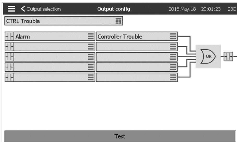
顶部的第一个框用于更改输出的名称。对于输出逻辑，可以选择 5 个数字输入的组合。每个输入都可以是列表中的一个警报或信号，并且可以通过点按屏幕左侧的“常开/常闭”接点符号颠倒顺序。逻辑“与”和“或”可以将所选择的输入组合起来，也可以点按屏幕右侧的“常开/常闭”接点符号颠倒顺序。
