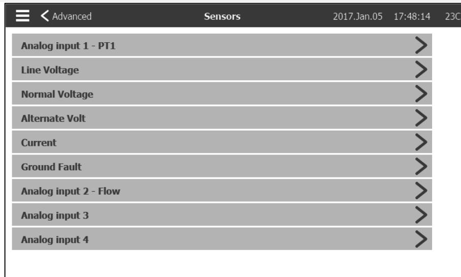
可以在此页面中校准所有模拟传感器、电压传感器、一个电流传感器和一个接地故障传感器。模拟输入 1 专用于压力传感器 1。其他模拟输入则取决于控制器的选项。
