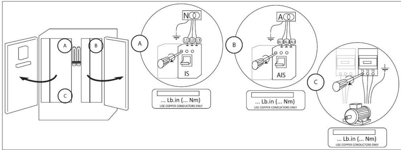
将常规输入电源、备用输入电源和电动机分别连接至对应的端子。按照扭矩标签上所示的相应扭矩紧固，并确认已全部连接好。
