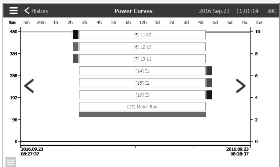
在此页面上，用户可以按时间查看 3 线电压、3 线电流以及电动机运行情况图表。点按屏幕，将会隐去或显示字幕。在屏幕上方点按所需的时间跨度（1 分钟到 2 周），可以更改时间尺度。图示两侧的蓝色箭头用于按时间导航。左下角的蓝色按钮可以打开用于生成此图表的表格。
