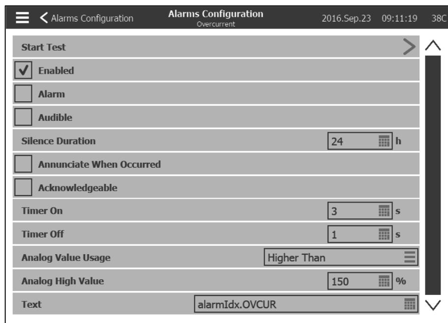
**开始测试：**使用此按钮可以测试警报。该测试只会宣布所选的警报。如果可以听到警报，它将激活警铃，并将激活与此警报关联的任何输出继电器。测试不会激活其他常见警报或其他组件。要停止测试，请按“停止测试”按钮。
