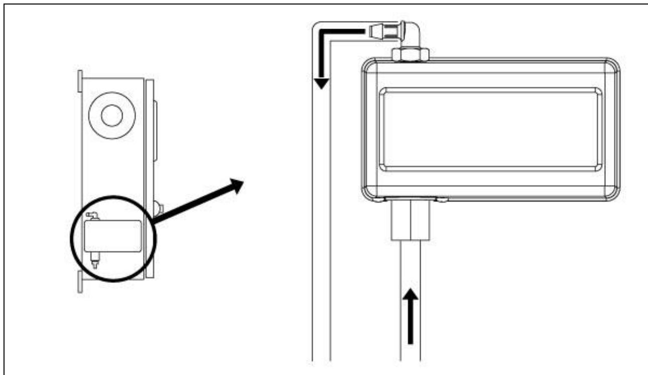
检查和/或安装合适的水管接头，以便进水和排水。必须要牢固安装并拧紧。请查阅塑料盖上的丝网印刷标记。
