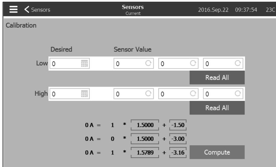
使用已校准的电流钳校准电流传感器。在控制面板通电而电动机不通电的情况下，在“期望值”下方的白框中输入“0”。按上面的“全部读取”按钮。按下 ViZiTouch 上的“手动启动”按钮启动电动机并等待电动机达到全速。用电流钳读取一条线路的电流值，然后按下面的“全部读取”按钮。在“期望值”下方、“高”右侧的白框中输入电流钳读取的值。按“计算”按钮。
