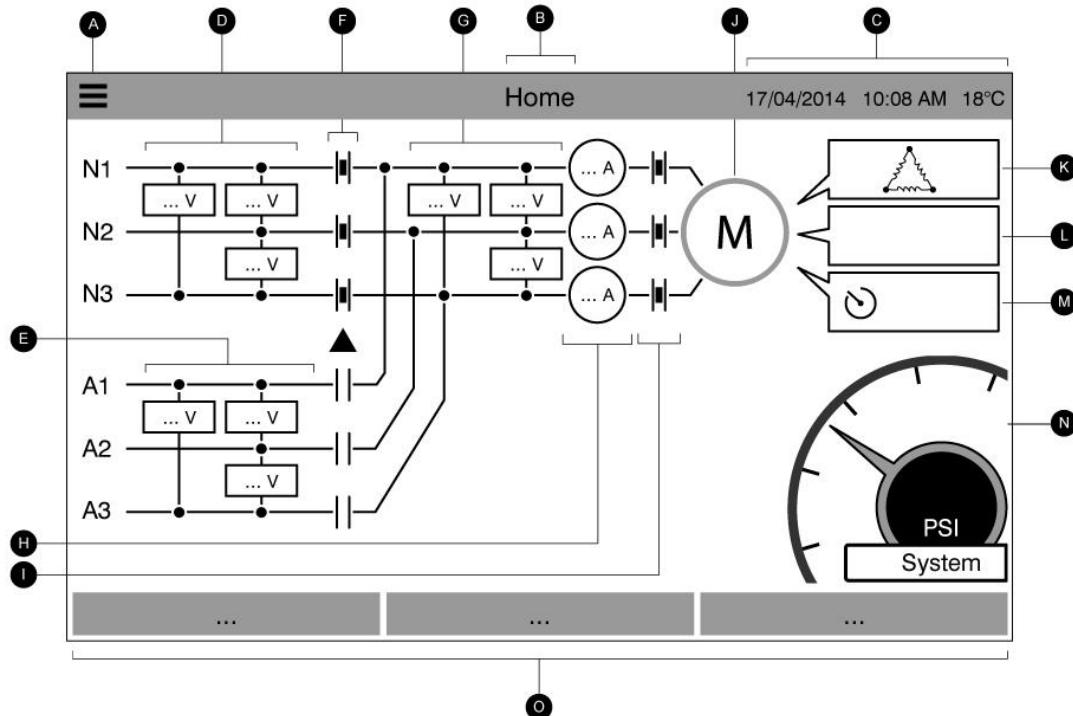
主页显示所有控制器状态和控制器的重要值。这包括所有电压、电流、压力、电动机状态，以及所有计时器和电动机启动序列。
