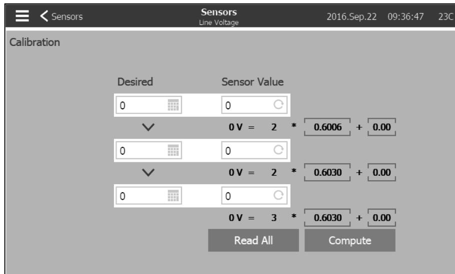
使用已校准的外部电压表校准线路电压传感器。采用已通电的控制面板：
