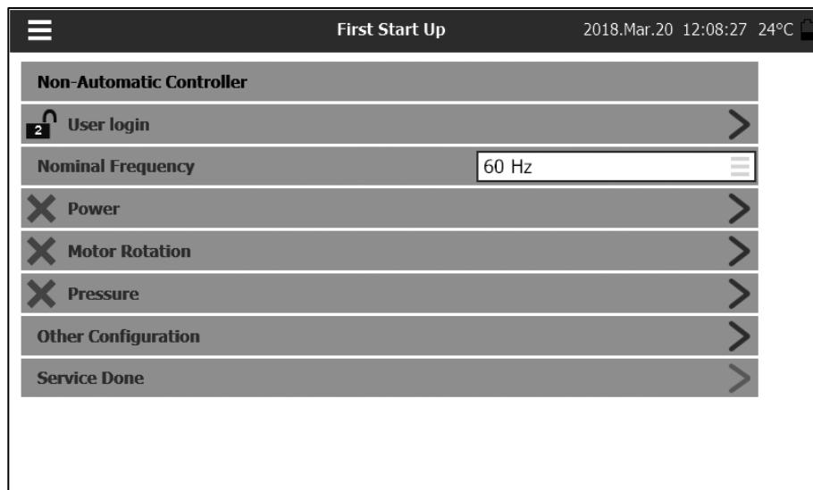
控制器一旦启动，便会出现“首次启动”页面。控制器将自动检测并显示电源的频率。然后可以手动选择电压的频率。
