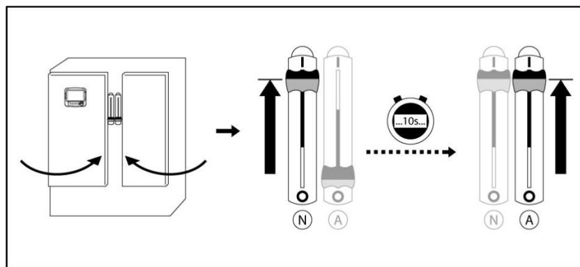
将门固定在关闭位置，然后将常规电源断路器（切断装置）置于“打开”位置。等待 10 秒钟，以便控制器正确加载，然后将备用电源断路器（切断装置）置于“开启”位置。检查控制器主屏幕上的读数。
