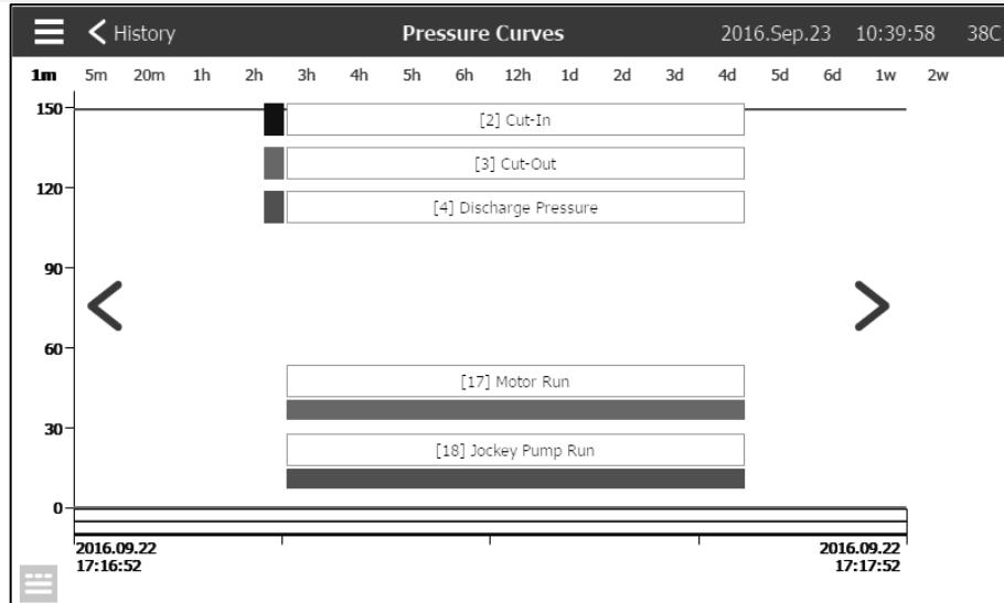
在此页面中，可以按时间查看“系统压力”、“接通”、“断开”、主泵“电动机运行”和“稳压泵运行”等的图表。点按屏幕，将会隐去或显示字幕。在屏幕上方点按所需的时间跨度（1分钟到2周），可以更改时间尺度。图示两侧的蓝色箭头用于按时间导航。左下角的蓝色按钮可以打开用于生成此图表的表格。
