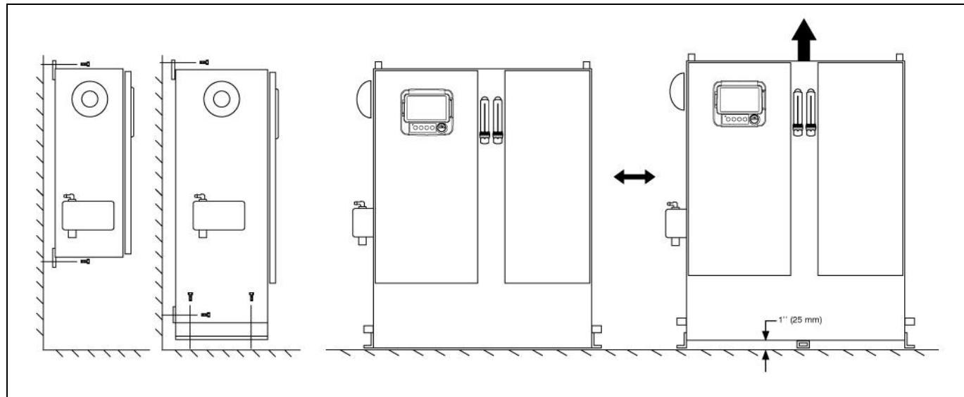
检查控制器是否已牢固安装在墙壁或安装架上。
