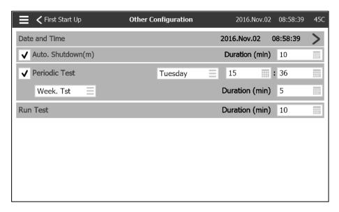
Revenez à la page de démarrage du contrôleur et appuyez sur le bouton "autre configuration". Saisissez l'heure et la date. Sélectionnez l'arrêt automatique et la durée de fonctionnement de la pompe après l'arrêt automatique si une butée automatique est souhaitée. Sélectionnez la fréquence à laquelle le test périodique se produira, le jour de la semaine, l'heure et la durée du test. Entrez également la durée du test de fonctionnement manuel.
