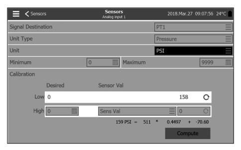
Pour le transducteur de pression PT1, le point bas (zéro) est automatiquement acquis lors de la première mise sous tension. Il peut être acquis de nouveau en appuyant sur la flèche ronde bleue. Le point haut doit être entré pour calibrer le capteur.
