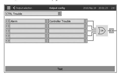
La première case à partir du haut permet de changer le nom de la sortie. Pour la logique de sortie, une combinaison de 5 entrées numériques peut être sélectionnée. Chaque entrée peut être une alarme ou un signal
