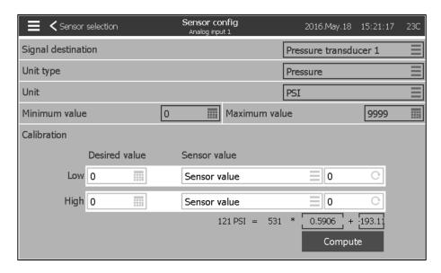
Tous les capteurs, à l'exception de la tension de ligne et du capteur de courant, peuvent être étalonnés de la même manière. La destination du signal, le type d'unité, l'unité, la valeur Min et Max sont des variables qui sont réglées en usine mais l'étalonnage peut être effectué dans le champ.
