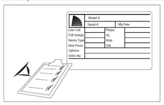
La plaque signalétique est l'étiquette la plus importante. Lire attentivement pour garantir la compatibilité entre le contrôleur et l'installation.
