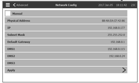
Cette page affiche l'adresse IP, le masque de sous-réseau, la passerelle par défaut et le DNS1-2-3 du contrôleur. Tous ces paramètres peuvent être modifiés manuellement en cochant la case en haut à gauche. Pour appliquer la modification, appuyez sur la flèche bleue dans le coin inférieur droit.
