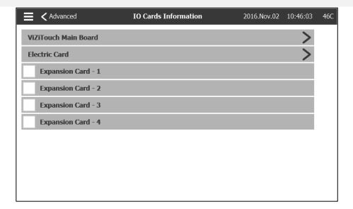
Cette page est utilisée pour visualiser les registres ViZitouch et I / O Card en appuyant sur les flèches bleues à droite de l'écran. Des cartes d'extension peuvent également être installées via cette page.
