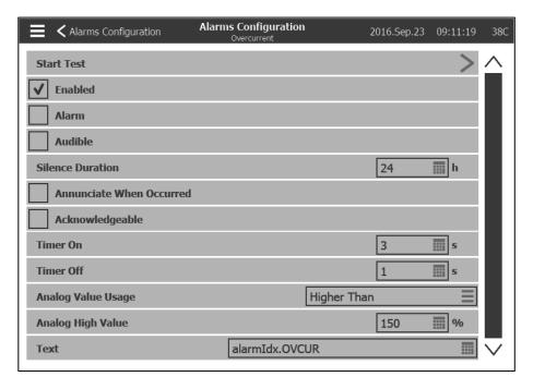
Démarrer le test: L'alarme peut être testée à l'aide de cette touche. Ce test n'annonce que l'alarme choisie. Il activera la sonnerie si l'alarme est audible et activera tous les relais de sortie associés à cette alarme. Le test n'activera pas d'autres alarmes communes ou d'autres composants. Pour arrêter le test, appuyez sur le bouton "Stop Test".
