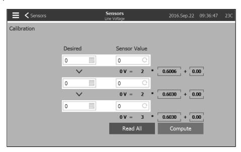
Pour calibrer le capteur de tension de ligne, utilisez un voltmètre externe déjà calibré. Avec le panneau de commande sous tension:
