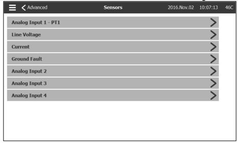
Tous les capteurs analogiques, les capteurs de tension, un capteur de courant et un capteur de défaut à la terre peuvent être calibrés en accédant à cette page. L'entrée analogique 1 est dédiée au transducteur de pression 1. L'autre entrée analogique dépend des options du contrôleur.
