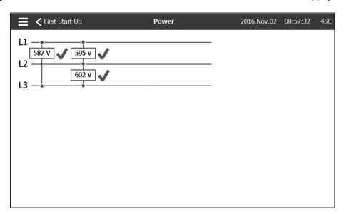
Vérifiez que la tension normale affichée sur L1-L2, L2-L3 et L1-L3 est la même que celle indiquée sur la plaque signalétique des contrôleurs de pompe à incendie. Le contrôleur de la pompe à incendie valide automatiquement la tension nominale par rapport à ce qui a été construit.
