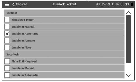
Cette page permet de configurer la sortie de verrouillage et les paramètres d'entrée d'interverrouillage. Pour être actif, ces options doivent être affectées à une entrée ou à une sortie sur la carte d'E / S.
