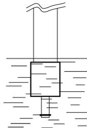
Le contact est OUVERT lorsque le flotteur est plongé dans le liquide
