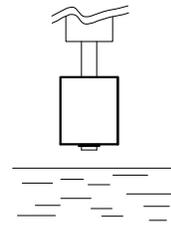
Le contact est FERMÉ lorsque le flotteur est au-dessus du niveau du liquide
