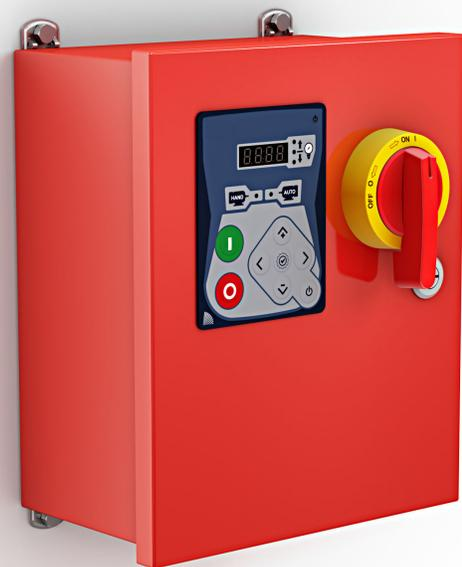
Los controladores de bombas Jockey para ajuste de presiones, modelo JP están diseñados específicamente para controlar las bombas Jockey de manera a mantener la presión de agua deseada en el sistema de bombas contra incendio al que presta servicio. La instalación de una bomba Jockey, previene arranques innecesarios de la bomba principal, debidos a pequeñas fugas y goteos en la cañería del sistema de rociadores.
